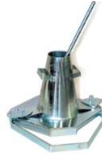
Fig.4.1 Slump Cone Apparatus
